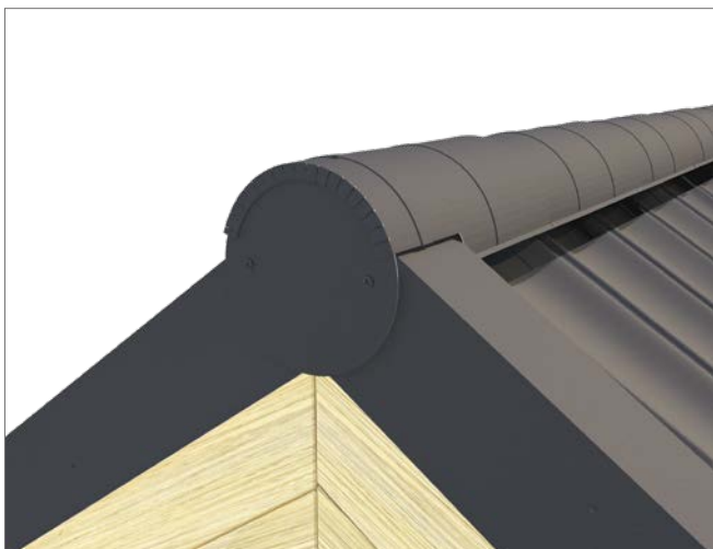
Eingeschnittene Segmente passend anformen
