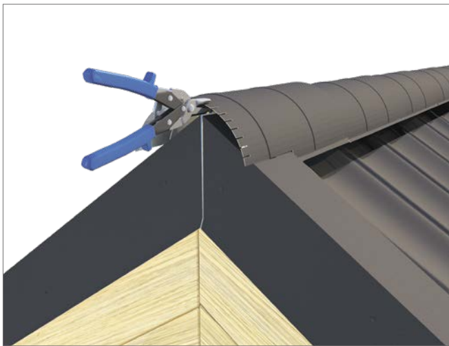
Überstand vom Firstelement alle 1,5 - 2 cm einschneiden
